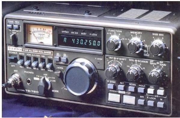
Este tipo de equipos están diseñados para utilizarlos en emplazamientos permanentes, traen incorporada la fuente de alimentación, de manera que el mismo se conecta directamente a la red eléctrica tanto de 110 V como de 220 V.
