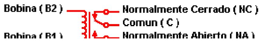
B1 y B2 son los terminales de alimentación de la bobina, cuando circule corriente por ellos el relé se activará cambiando de posición su interruptor interno y el terminal C se conectará con el terminal NA.
